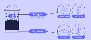
Les déchets alimentaires sont acheminés vers un centre de biométhanisation où ils sont stockés dans de grandes cuves. Dans ces digesteurs, des cuves en béton chauffées à 40°C, la matière se dégrade- sous l'action des bactéries- et produit du biogaz, constitué à 45% de CO² et à 55% de méthane. C'est ce "biométhane" qui est récupéré par filtration, avant d'être injecté dans le réseau de distribution de gaz naturel.
